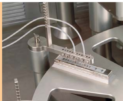
Dosieren der Flüssigkeit mittels Peristaltikpumpen
