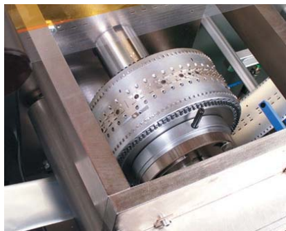
Präzise Stanzen mittels servo-gesteuerter Werkzeuge
