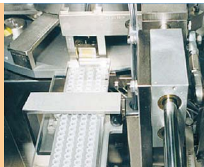
Zuführen von gefüllten Diagnosekapseln in eine Montagemaschine
