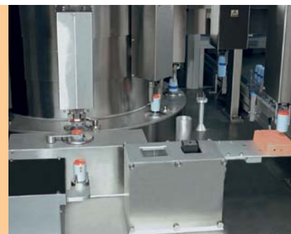
Pulverfüllung und Kompaktierung in der Pulverkammer
