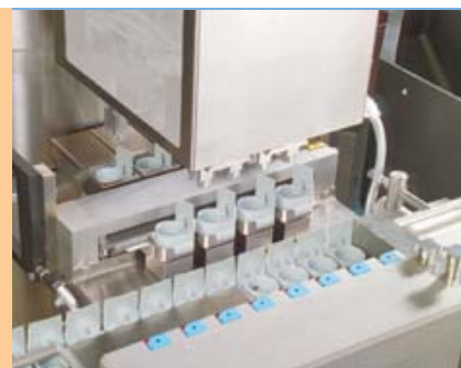
4-faches Übersetzen der Unterteile in den Rundläufer
