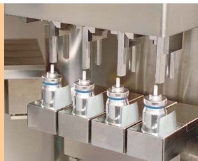
Überprüfen der montierten Produkte auf das korrekte Einpressmaß
