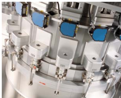
Transport der zu prüfenden Inhalatoren im Rundläufer
