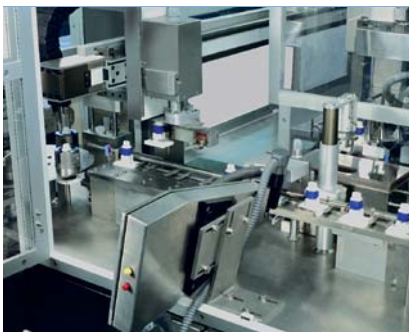
Tara-Brutto-Verwiegung mit Laserkennzeichnung und Schlechteilnahme
