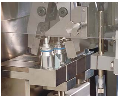
Eindrücken der Kartuschen in die Zähler-Unterseite
