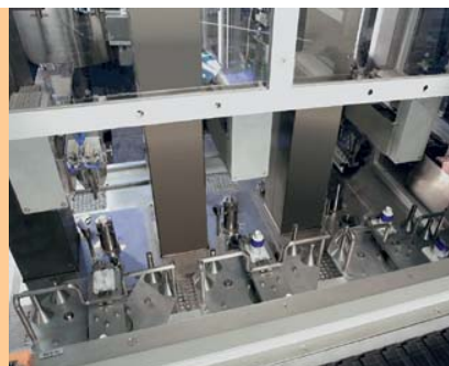
Rundläufer zur Endmontage des Inhalators mit Funktionstest
