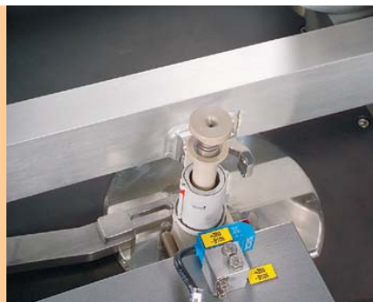
Der Laser kontrolliert den Sprühstrahl in einem definiertem Toleranzbereich
