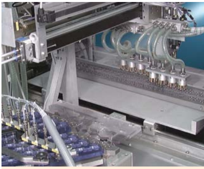
Übersetzen von Knopfzellen-Batterien in die tiefgezogene Folienbahn
