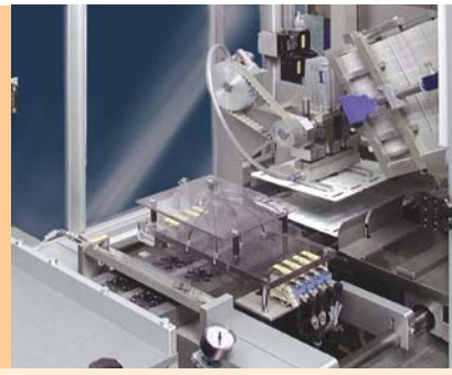
Zuführung der Trägerkartonage und Einsetzen in die Produktkette
