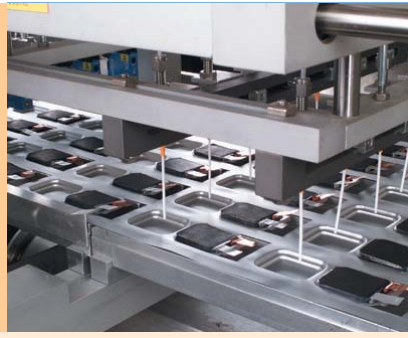
Dosierung von Elektrolytflüssigkeit unter Stickstoffatmosphäre
