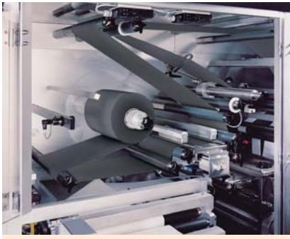
Zuführen von Folienmaterialien zur Herstellung von Bi-Zellen
