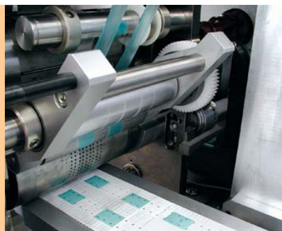
Schneiden der Folienbahn und Transport zur Stapelung
