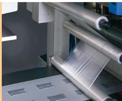
Laminieren einer Deckfolie über das frisch dosierte Gel
