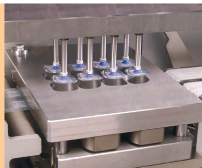
Pick-and-Place-Übergabe der Pflaster auf das Vakuumtransferband zur Beutelverpackung
