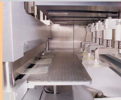
Bei der getakteten Arbeitsweise wird die Bahn mittels Greiferbacken vorgezogen
