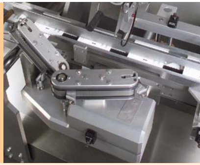
Verschließen der Packungen mit einem Etikett
