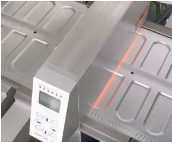
Kamerakontrolle der tiefgezogenen Blister auf Risse
